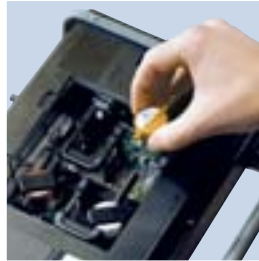
Sustitución fácil y rápida de los sensores de medición in situ por el usuario
