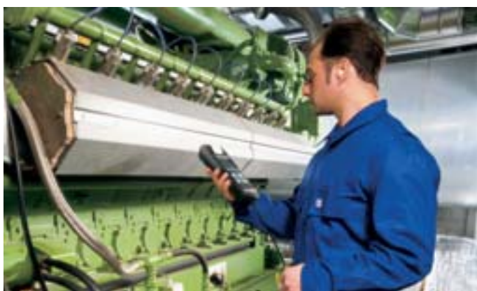
testo 350 XL: mediciones portátiles en motores (O 2 , CO, NO, NO 2 )
