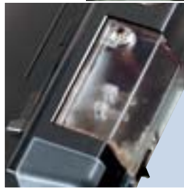
Trampa de condensados - Preparadora de gases integrada Peltier con bomba para la eliminación de condensados durante mediciones a largo plazo
