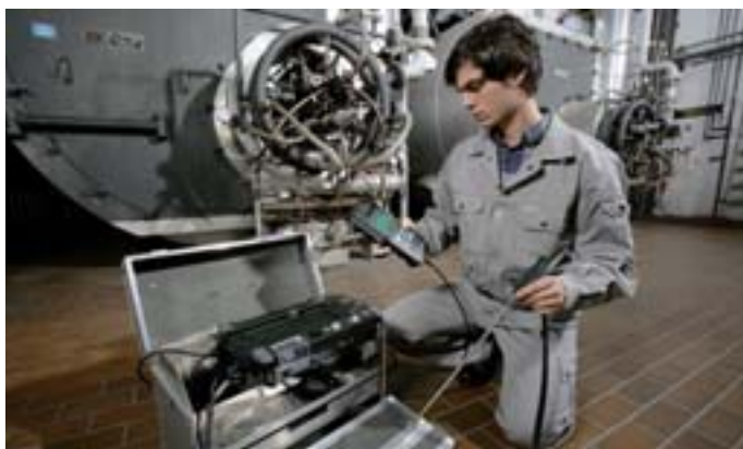
testo 350 S: set para control rápido de emisiones en calderas industriales (O 2 , CO, NO)
