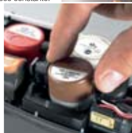
Los sensores de medición se pueden cambiar in situ de manera fácil y rápida por el usuario
