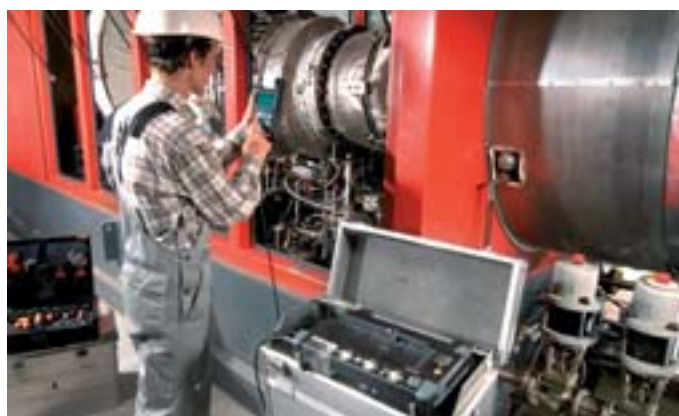
testo 350 XL: mediciones portátiles en turbinas de gas (O 2 , CObajo, NObajo, NO 2 )
