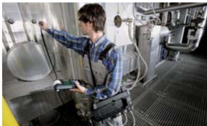
testo 350 XL: set estándar para mediciones en sistemas de proceso (O 2 , CO, NO, NO 2 )
