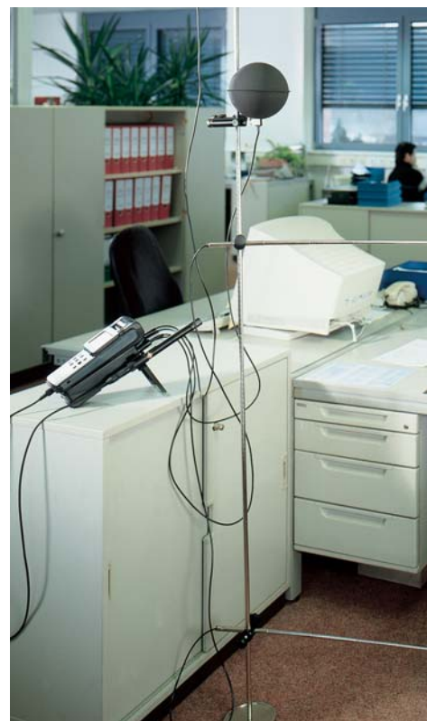
El confort personal está influenciado por la humedad relativa, la velocidad del aire, las temperaturas de superficie y la calidad del aire interior. El testo 454 le proporciona una determinación completa de estos criterios.
