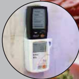
El recolector de datos testo 580 memoriza y transmite datos in situ a un PC
