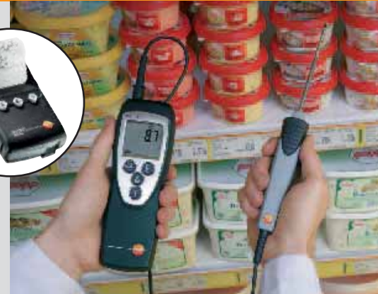
Inspección de un mostrador refrigerado para averiguar si dispone de suficiente refrigeración
