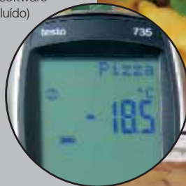
Muestra sitio y parámetro. Se pueden memorizar hasta 99 nombres de producto en el instrumento
