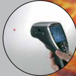
Optica zoom 2: enfoco cercano (1 mm, distancia 70 mm) con indicador láser de 2 haces
