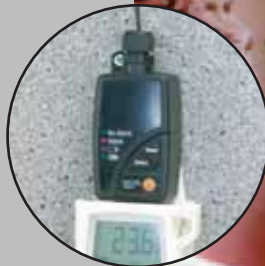
Salida de señal de alarma testo 581 para aviso fiable de límites excedidos
