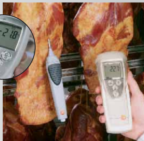
Medición de la temperatura por penetración al ahumar alimentos, transmisión sin cables de los datos de medición
