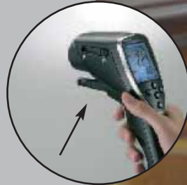
testo 845, con módulo adicional de humedad para medir la humedad ambiente y determinar la distancia del punto de rocío
