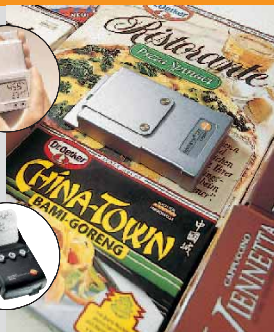
testostor 171-0 controla constantemente fluctuaciones de temperatura
