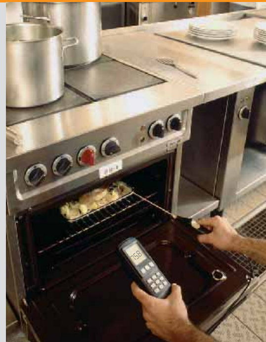
Control de la temperatura de cocción
