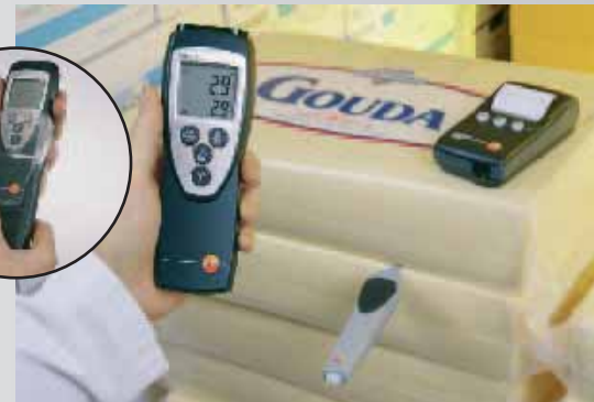
Control práctico durante el curado del queso; transmisión por radio de los datos de medición, sin necesidad de cables
