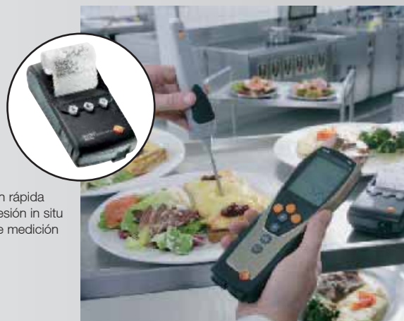
Comprobación de la temperatura durante la entrega de alimentos; sin cables molestos gracias a las sondas por radio
